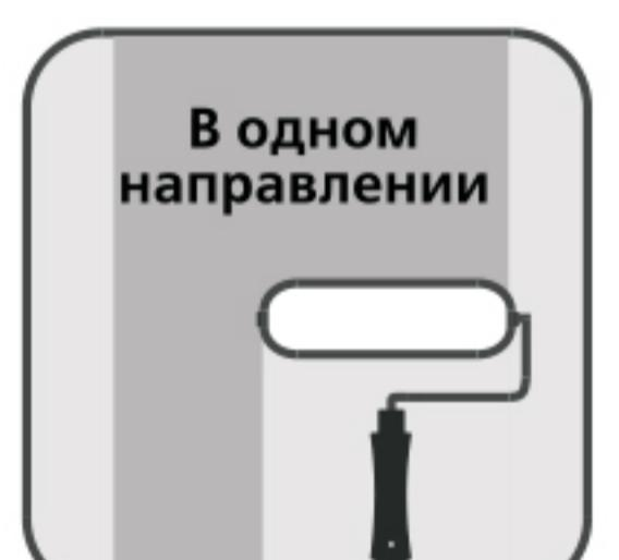
7 Сразу после нанесения материала на поверхность, необходимо раскатать краску в одном и том же направлении (от пола к потолку, либо наоборот). Это необходимо для того, чтобы содержащиеся в ней металлические пигменты были по возможности максимально ориентированы параллельно друг другу и поверхности, что увеличит суммарный эффект отражения световых лучей от частиц пигмента, создавая тем самым ярко выраженный шелковистый блеск.
