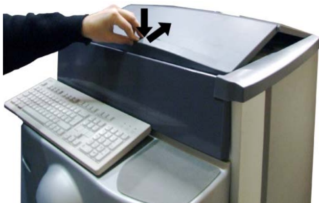
Рис. 8-9 Открытие крышки: Нажмите на передний край и толкните назад.
