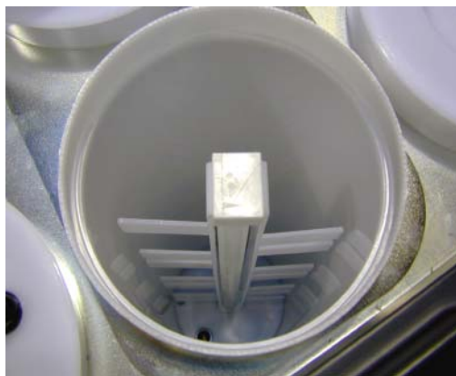
Рисунок 7-4: Перемешивающий механизм в канистре для колоранта
