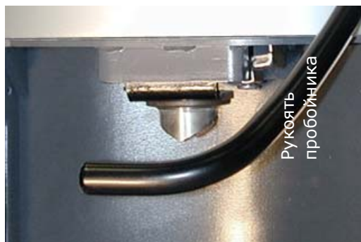
Рисунок 7-5: Лезвие для пробивания крышки банки с краской в нижнем положении.
